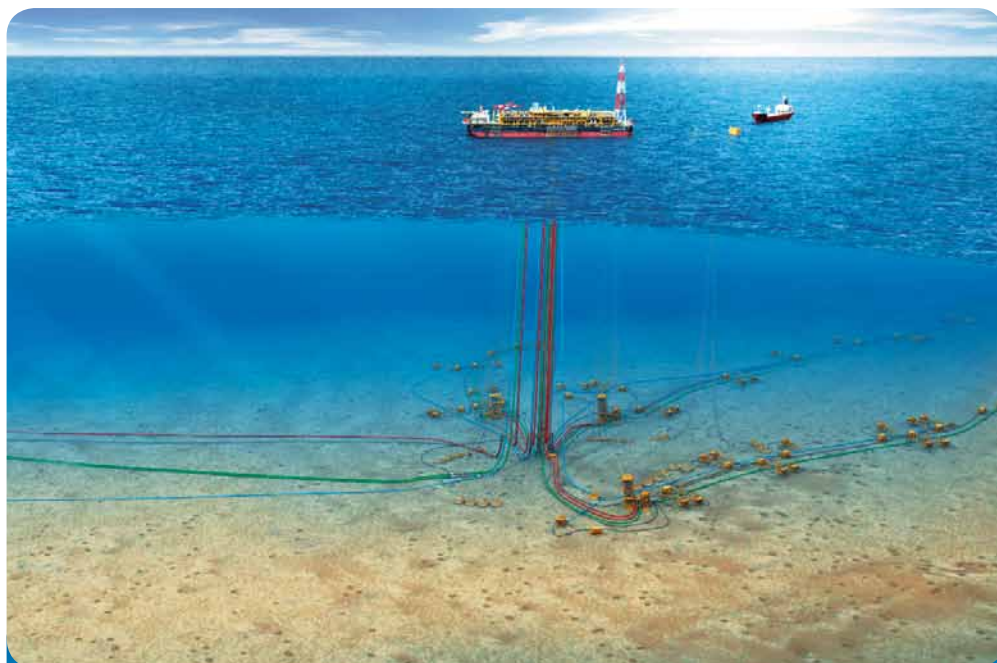
Le schéma de développement de Pazflor repose en grande partie sur des installations sous-marines de séparation et de pompage.
