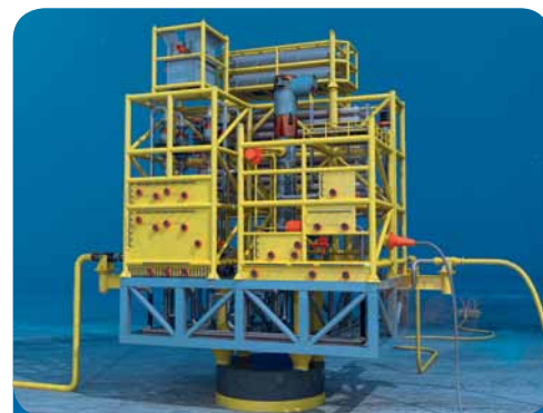
L'unité sous-marine de désulfatation d'eau de mer SPRINGS ( Subsea Processing and Injection Gear for Seawater ), en cours de développement.
