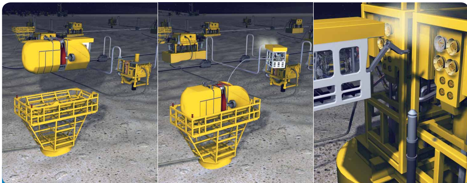
Dans le dispositif SWIMMER, les opérations de contrôle et de maintenance sont supervisées depuis la surface et exécutées entièrement en sous-marin par ROV.
